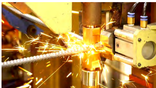
溶接工程 (高性能型特殊スポット溶接 : 拡大)
