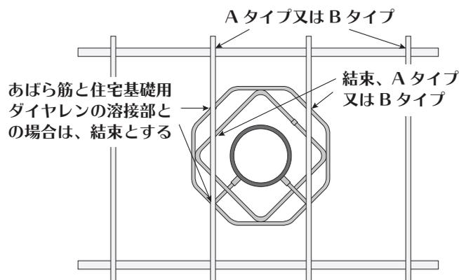
日本建築センター評定区分：組立鉄筋 Aタイプ、組立鉄筋 Bタイプ、段取り筋溶接（仮組み溶接鉄筋工法）
